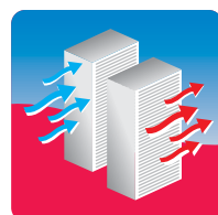
Рекуператор с гликолевым контуром
