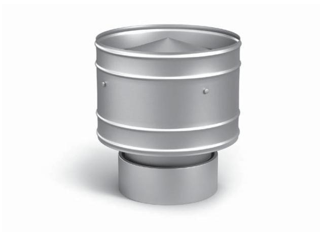
Дефлекторы устанавливаются на вытяжных шахтах в системах естественной вентиляции и служат для усиления тяги под воздействием ветра.
