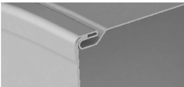
Рис. 3 Сборка корпуса вентилятора на питтсбургском фальце
